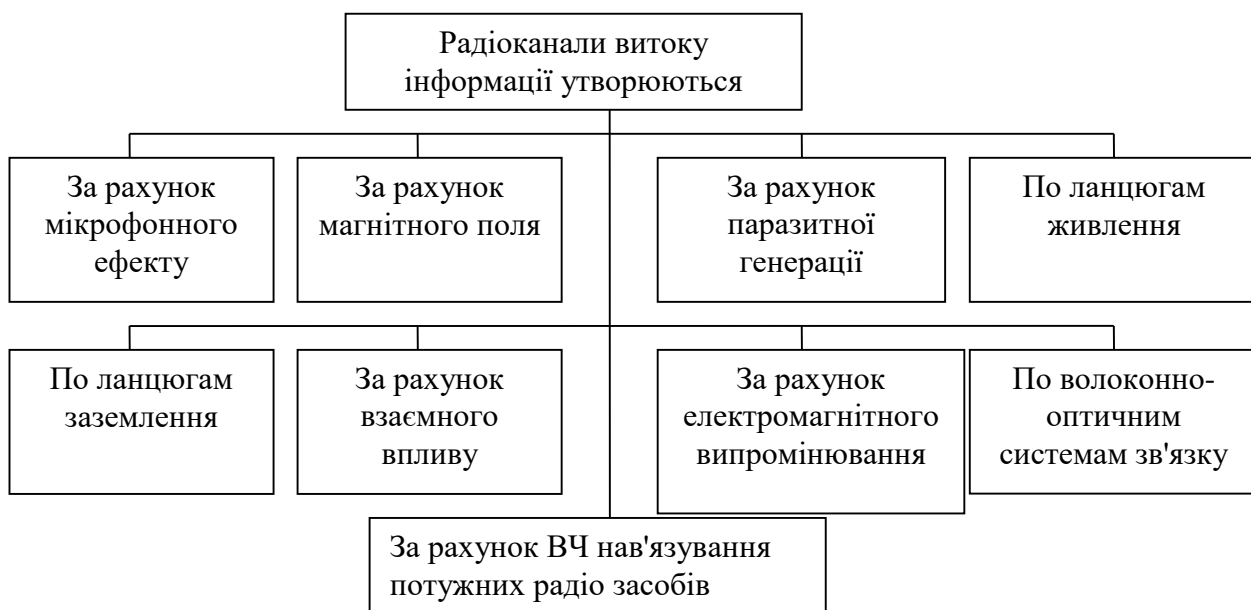
Рис.1.6 Структура радіоканалів витоку інформації
