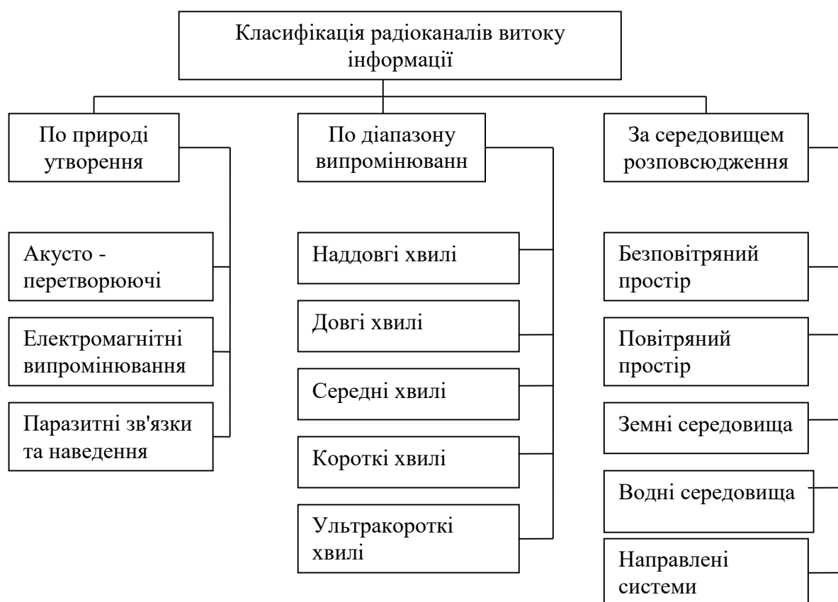
Рис.1.7 Класифікація радіоканалів витоку інформації за природою виникнення, діапазону випромінювання та середовищі розповсюдження
