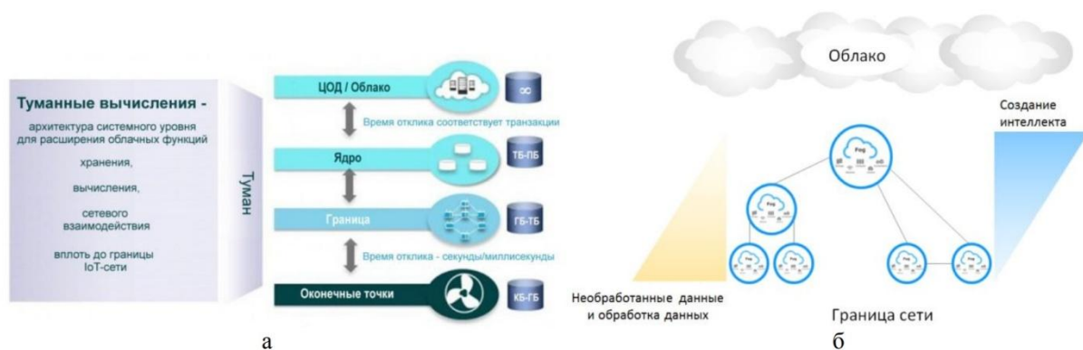
Рис. 3.6 "Туманні обчислення" в ієрархічній багаторівневій моделі обчислень IoT
