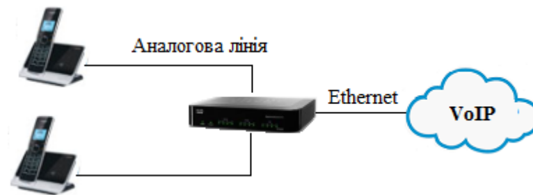
Рис. 3.9. Схема тестування адаптерів VoIP-телефонії
