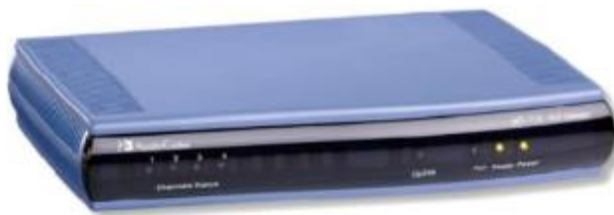
Рис. 3.8. VoIP-шлюз Audiocodes MP-114 / FXS
