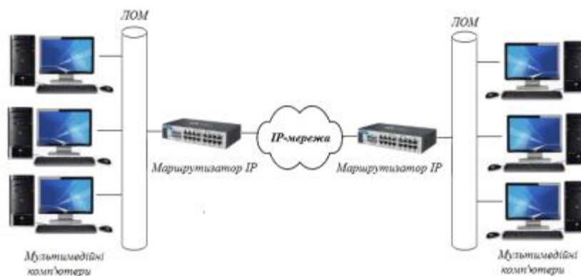
Рис. 1.4. Схема зв'язку «комп'ютер - комп'ютер»
