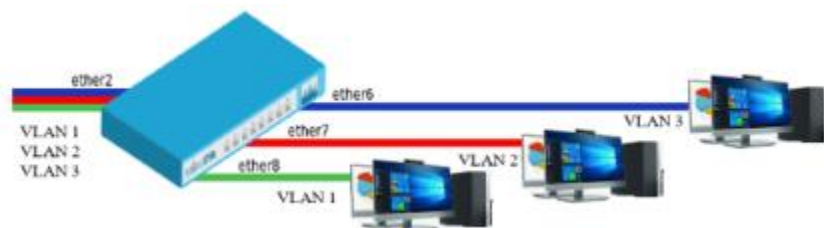
Рис. 1.7. Використання механізму VLAN в IP-телефонії
