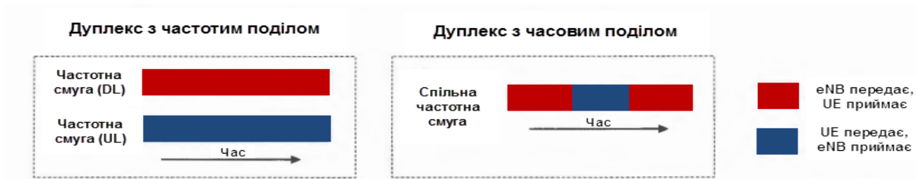
Рисунок 1.10. Принцип дуплексу з частотним та часовим поділом
