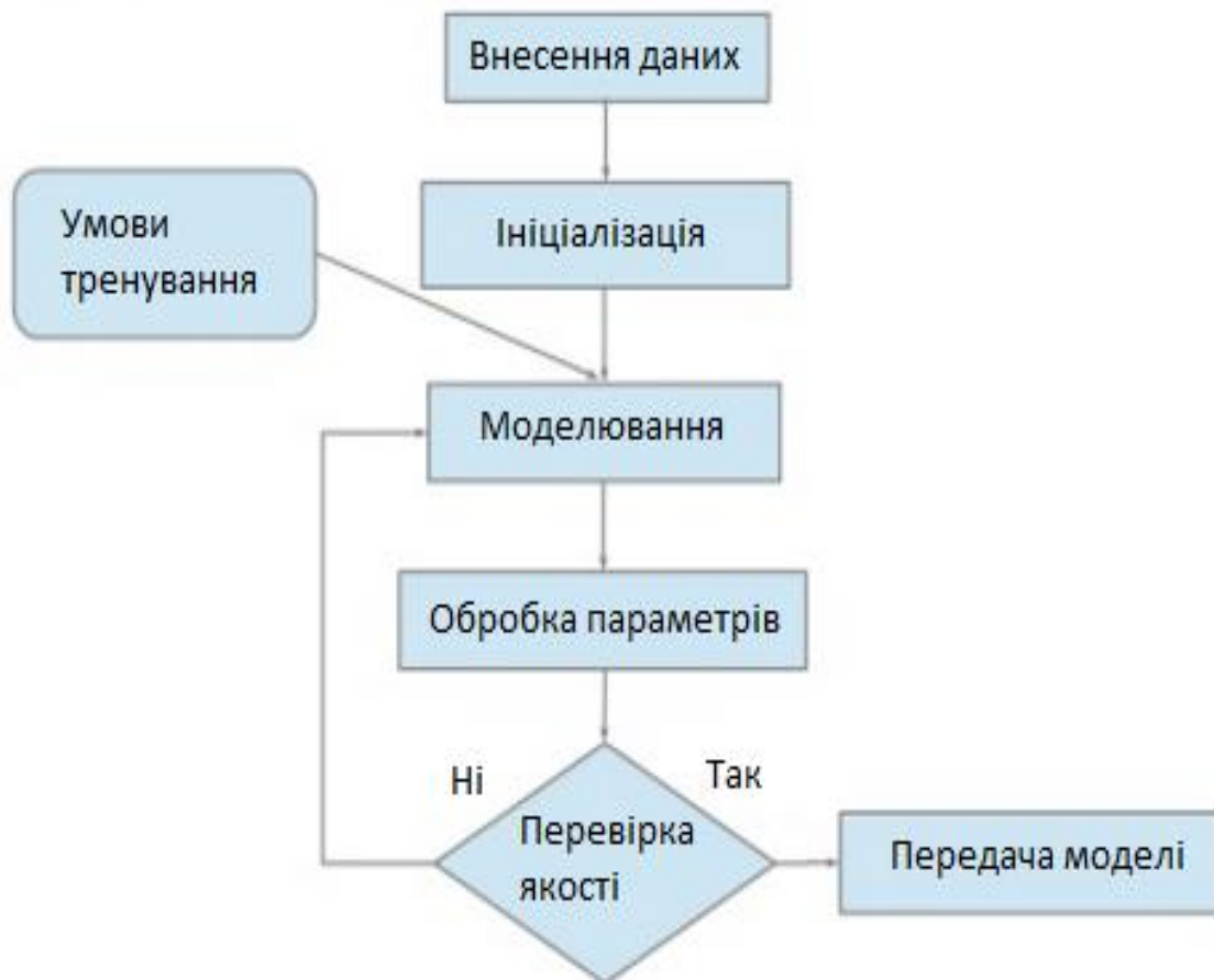
Рис. 3.8 – Блок схема роботи бібліотеки PyBrain
