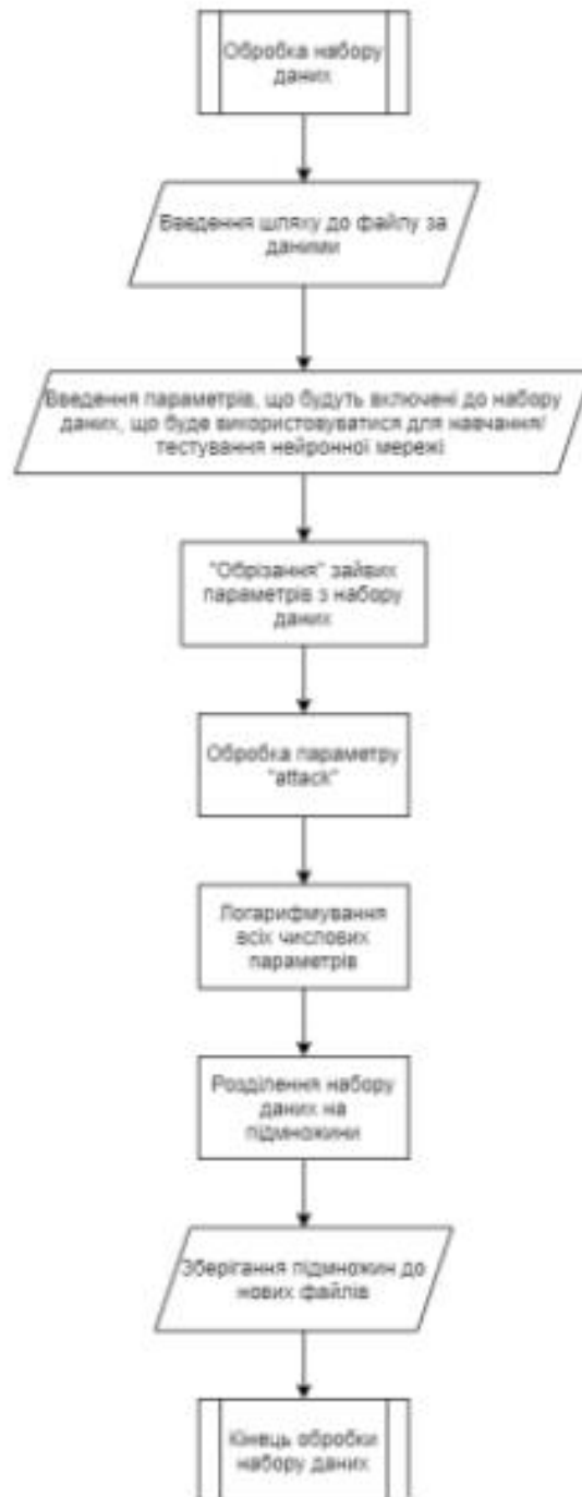
Рисунок 4.6 - Алгоритм роботи програмного модулю для обробки початкового набору даних
