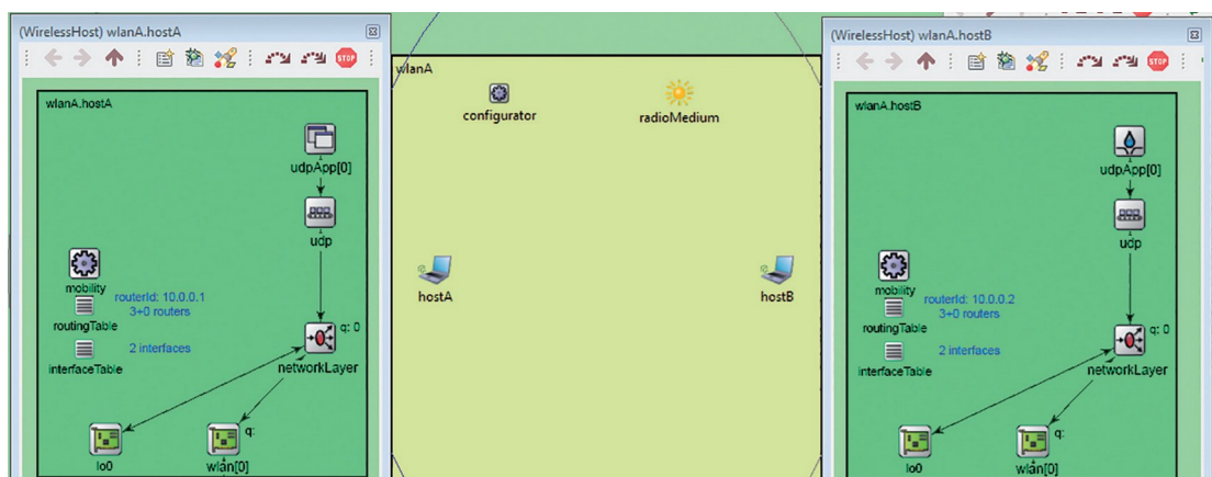
Рисунок 3.3 - Модель WLAN та внутрішня структура композитних модулів вузлів hostA та hostB: udpApp[0] — прикладний модуль, udp — модуль протоколу UDP, networkLayer — мережевий рівень, Io0 — закільцьований мережевий
