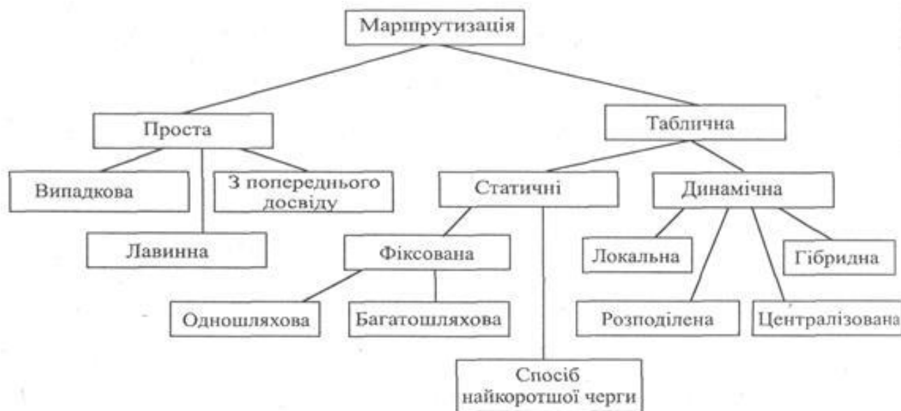
Рисунок 1.1 - Способи маршрутизації в мережах передачі даних
