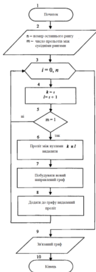
Рисунок 2.4 - Алгоритму для випадку видалення одного прольоту
