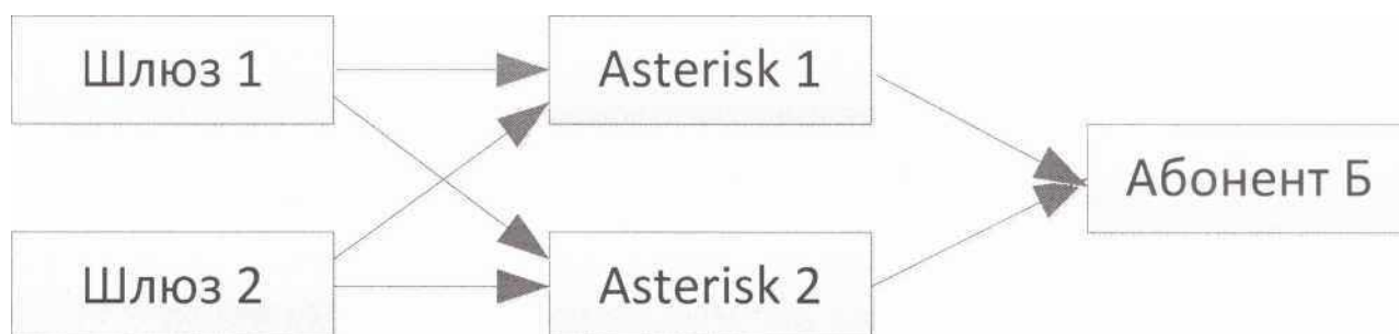
Рисунок 3.25 Вхідний виклик з корпоративної або ТМЗК до абонента IP-телефонії
