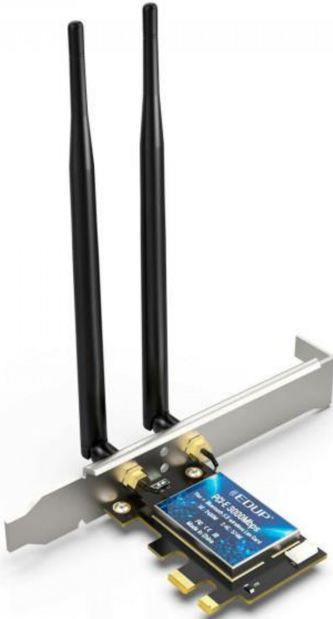
Рисунок 4.9 - Wi-Fi адаптер EDUP Intel AX200 PCI-e 2.4Gbps 802.11ax
