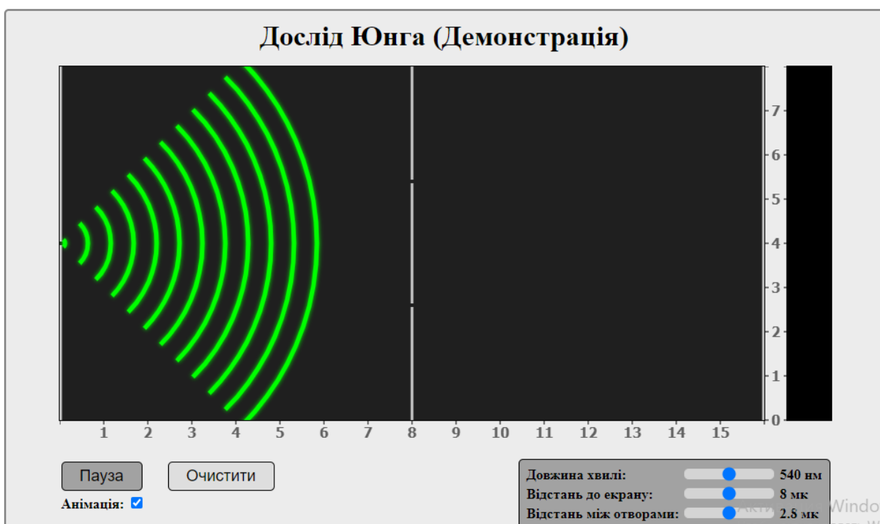
Рисунок 3.25 – Вікно проведення дослідів вивчення дослідів Юнга апаратно програмного комплексу для виконання лабораторних і практичних робіт
