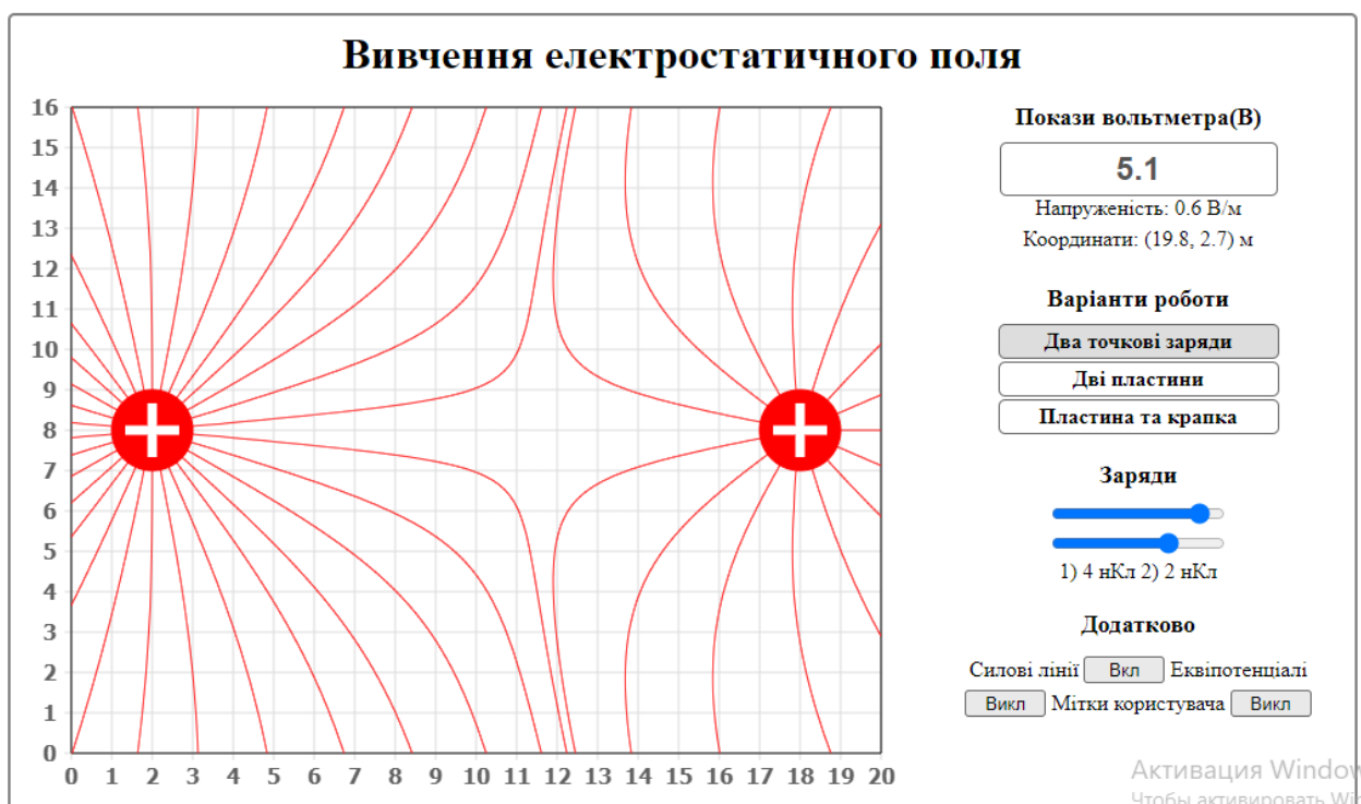
Рисунок 3.15 – Вікно проведення дослідів вивчення електростатичного поля апаратно програмного комплексу для виконання лабораторних і практичних робіт
