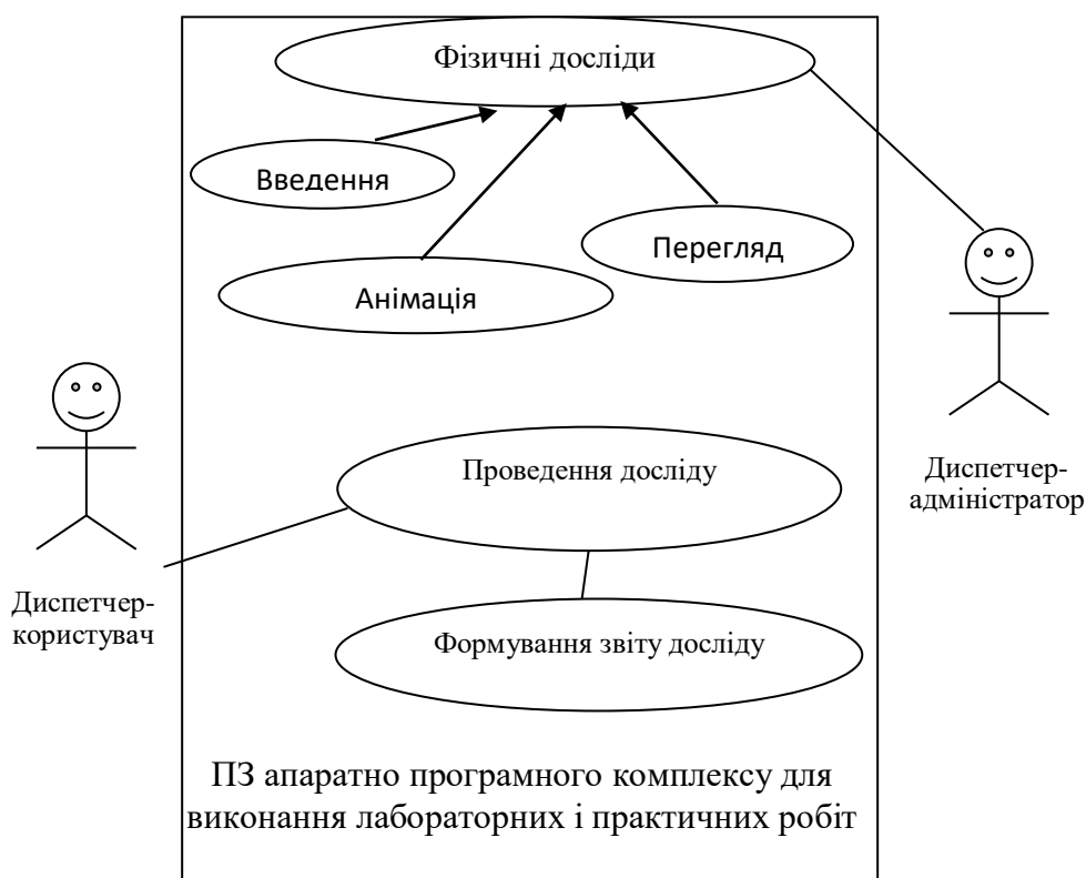
Рисунок 3.2 – Діаграма варіантів використання апаратно програмного комплексу для виконання лабораторних і практичних робіт
