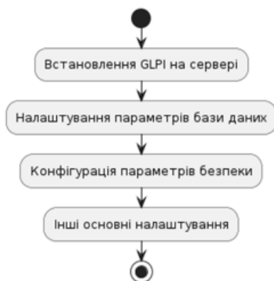
Рисунок 3.1 – Встановлення GLPI на сервер
