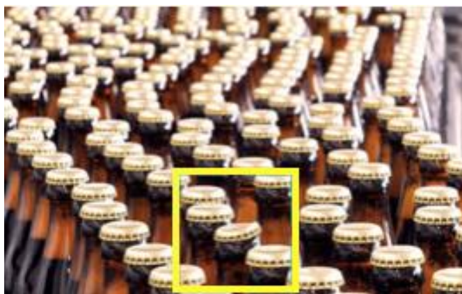
Рис. 1.14 – Пошук браку на виробничій лінії за допомогою Object Detection
