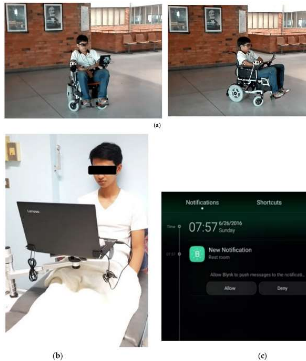
Рис.3.14. Експлуатаційне випробування для (а) мобільної допоміжної системи (інвалідного візка з керуванням оком); (б) стаціонарна допоміжна система; (с) сповіщення про виклик медсестри.
