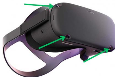
Рис.1.4 Система відстеження руху на самих окулярах VR
