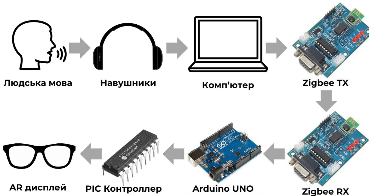
Рис.3.3 Процес конвертації людської мови в текст за допомогою вказаних на схемі засобів
