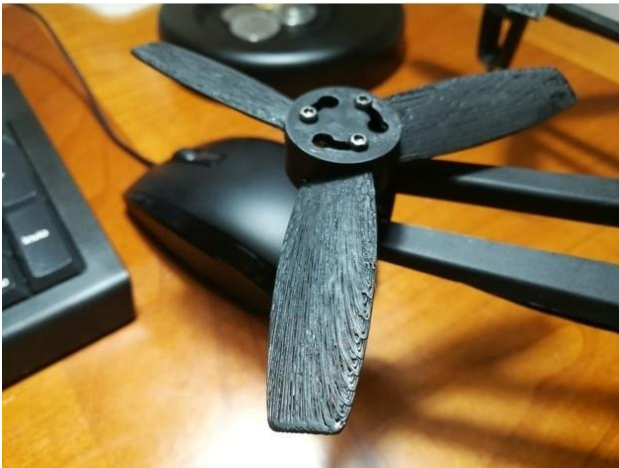
Рисунок 3.5 - Нерівності та шорсткість поверхні після друку через цифрову обробку світла
