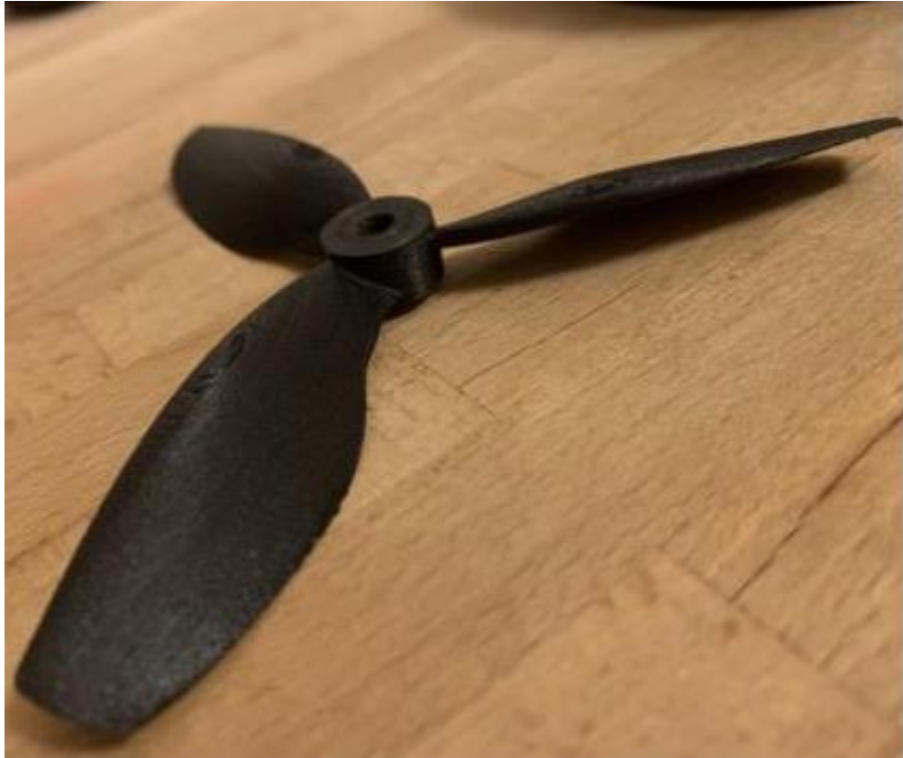
Рисунок 3.6 - Пропелер, надрукований за допомогою технології FDM
