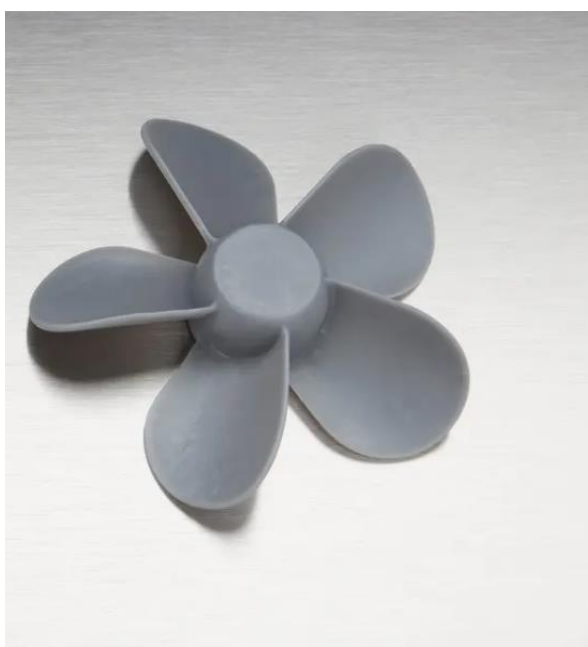
Рисунок 1.3 - деталь, надрукована на SLA принтері
