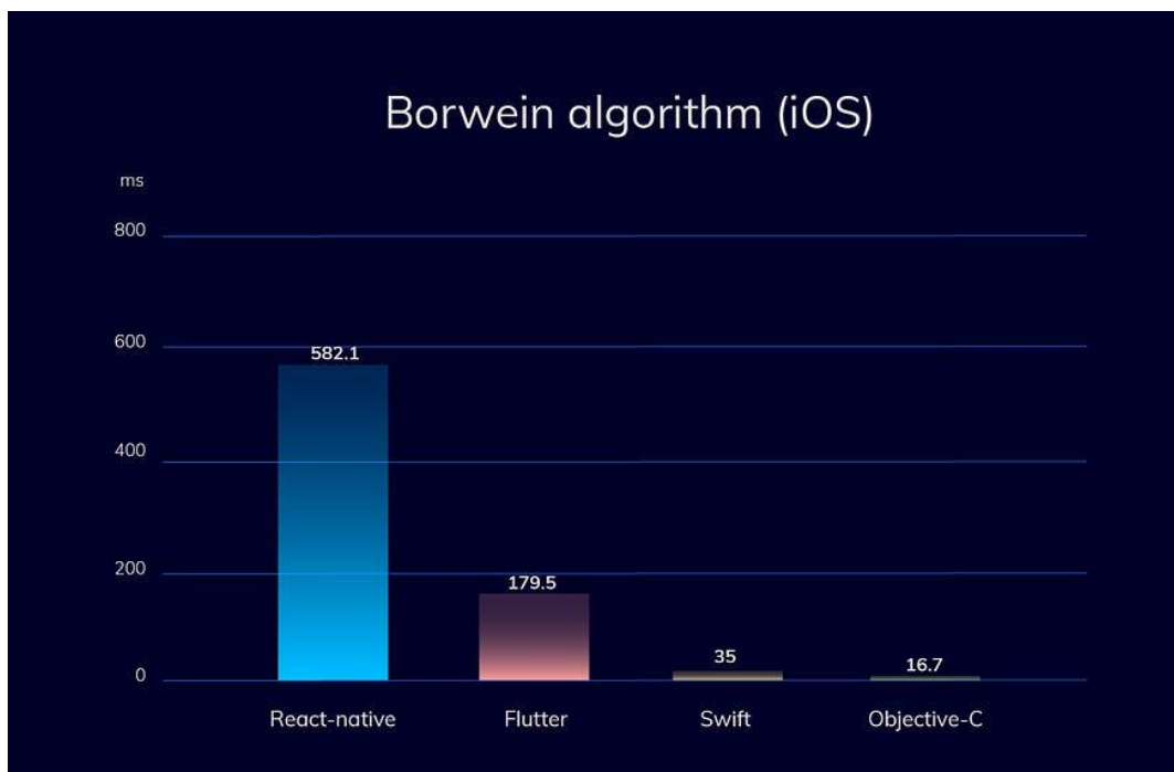
Рисунок 2.12 - Тест із інтенсивним використанням ЦП (алгоритм Борвейна) для iOS [23]
