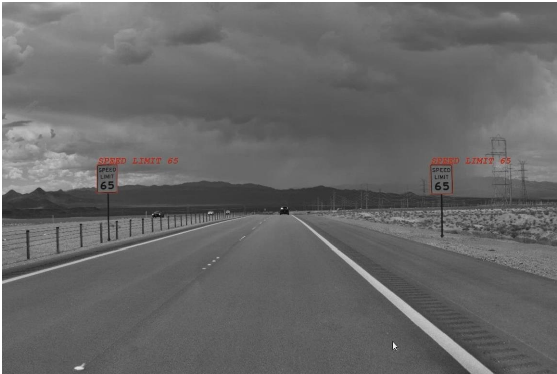
Рис. 2.16 Розпізнавання дорожніх знаків використовуючи технологію комп'ютерного зору Mobileye [13]
