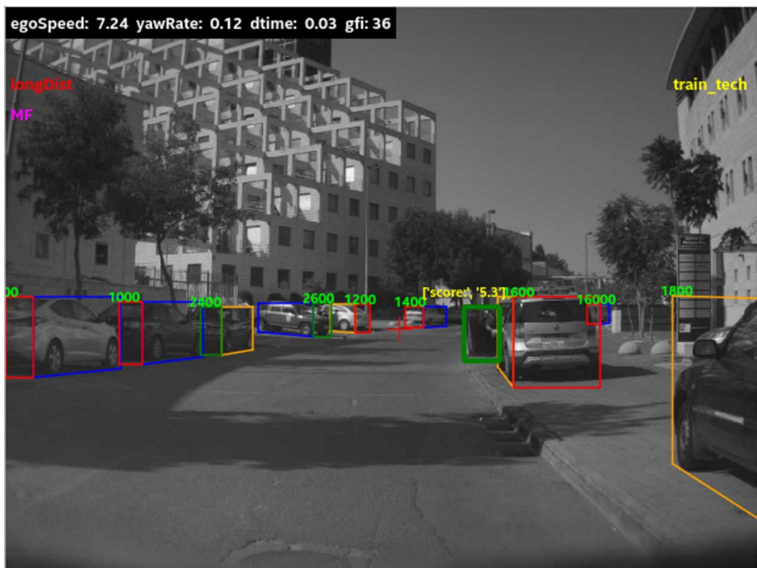
Рис. 2.15 Аналіз дорожньої сцени з використанням технології комп'ютерного зору системи Mobileye [13]
