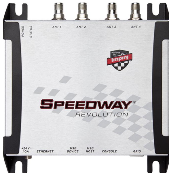
Рис 2.5 Impinj RFID system
