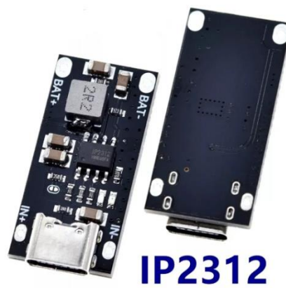
Рис. 3.8 Плата зарядки на мікросхемі ір 2312
