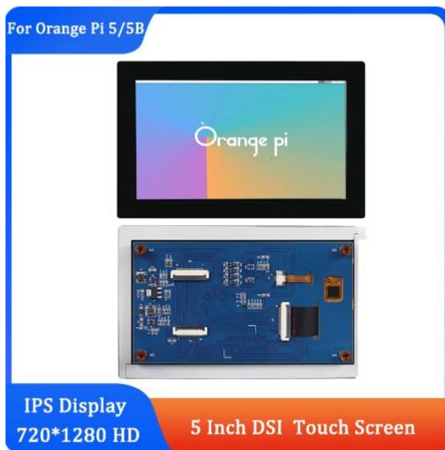
Рис. 3.2 Сенсорний дисплей WKS50HD005-WCT
