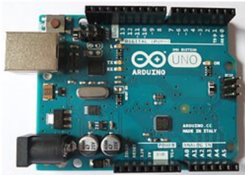
Рисунок 2.14 - Arduino UNO R3 - версія SMD з інтерфейсом USB та мікроконтролером ATmega 328.
