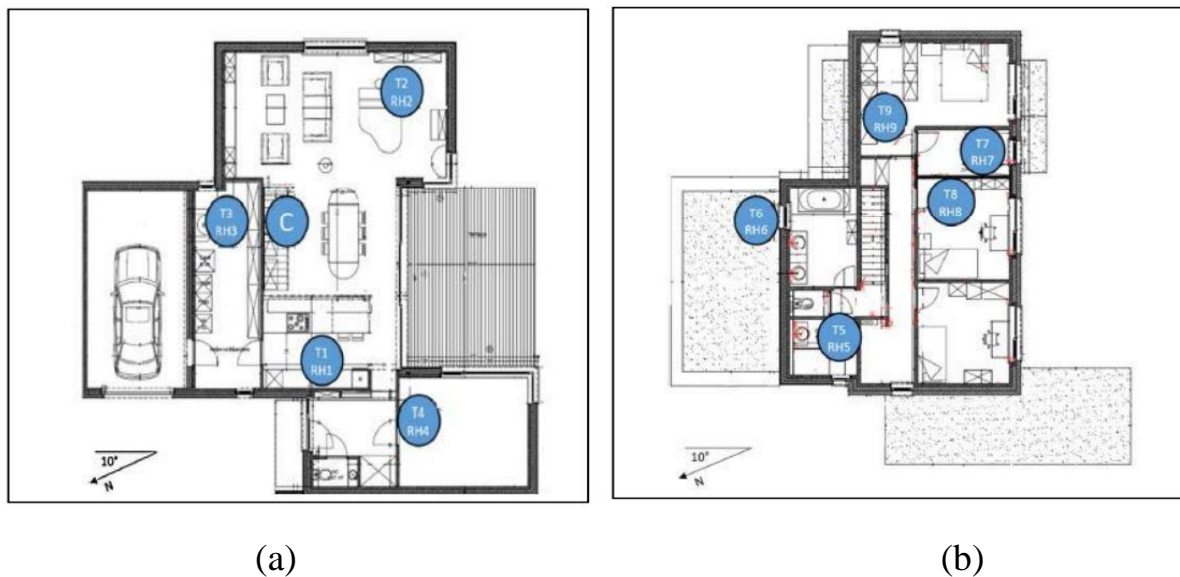
Рисунок 3.2 - Розташування датчиків температури та вологості у приміщенні: (a) перший поверх; (b) другий поверх
