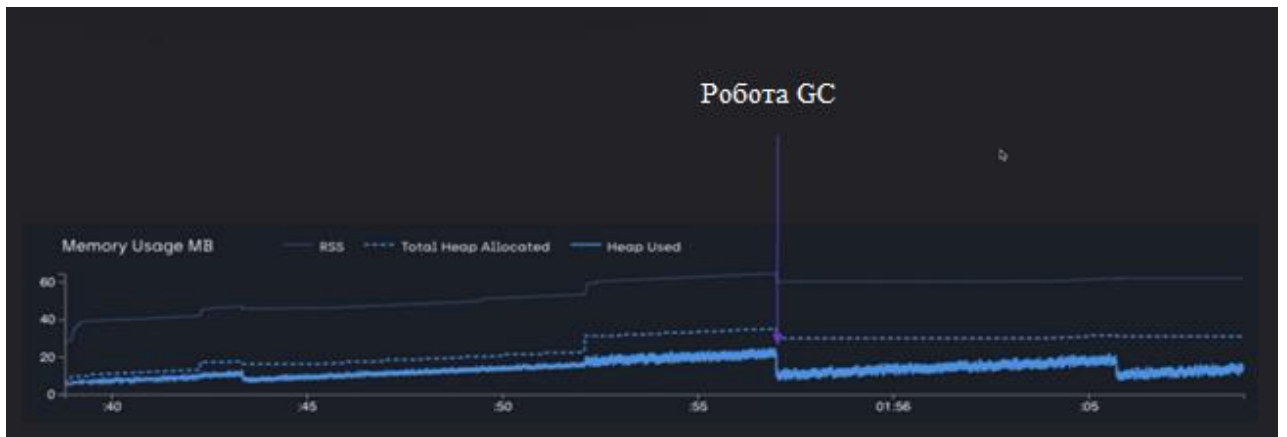
Рис. 2.3 Приклад роботи Garbage Collector під час роботи застосунку
