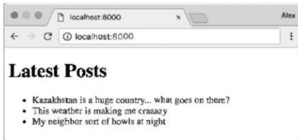
Рис. 1.4 HTML-відповідь від веб-сервера, який читає заголовки з файлу JSON та повертає результати у вигляді веб-сторінки
