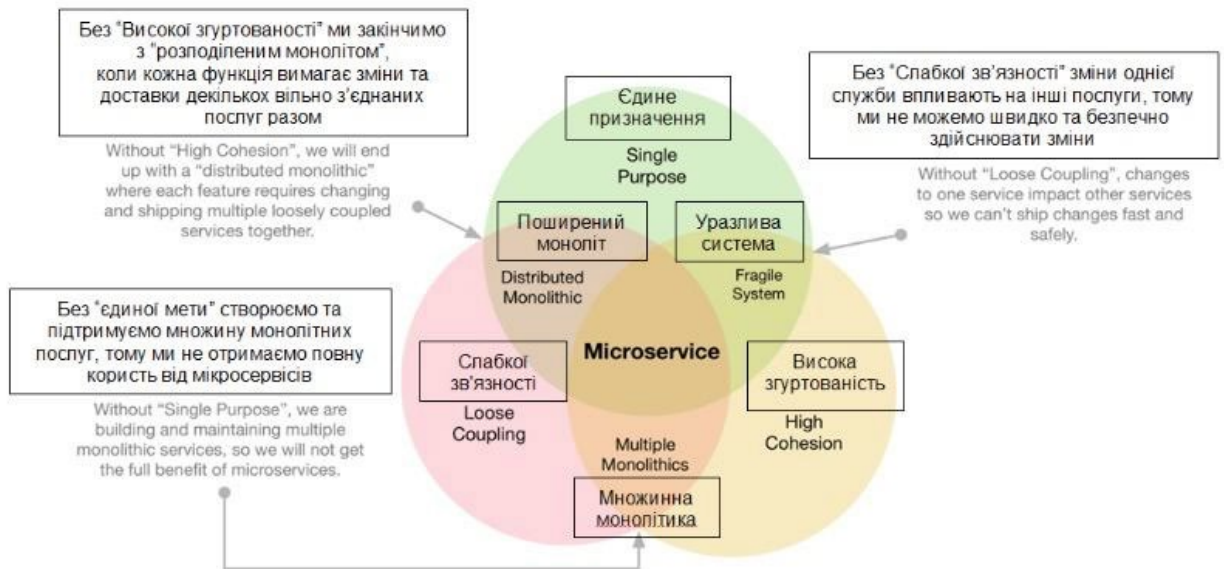
Рис.4.1. Три принципи моделювання (проектування) мікросервісів [23]
