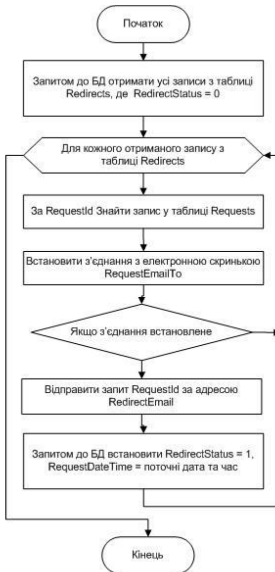
Рис. 3.7. Узагальнена блок-схема функціонування сервісу взаємодії з електронною поштою у режимі перенаправлення листів
