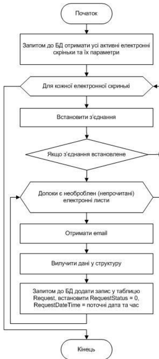
Рис. 3.6. Узагальнена блок-схема функціонування сервісу взаємодії з електронною поштою у режимі обробки вхідних листів
