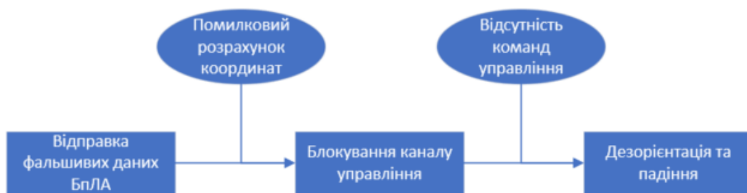
Рисунок 2.10 – Схематичне зображення етапів кібератаки на БпЛА
