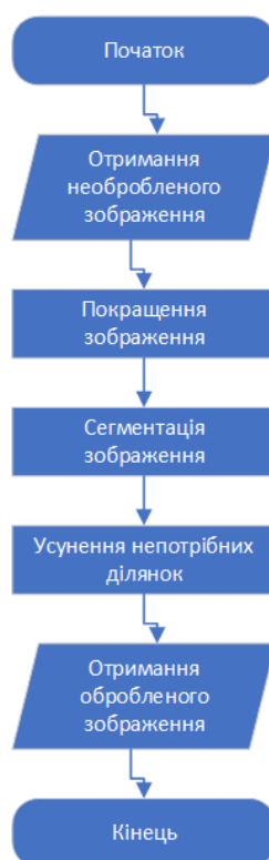
Рисунок 3.1 – Блок-схема алгоритму попередньої обробки зображення
