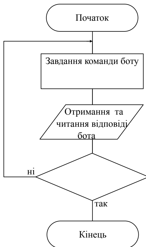
Рис. 2.2 Блок-схема алгоритму роботи чат-бота, що надає інформацію про погодні умови
