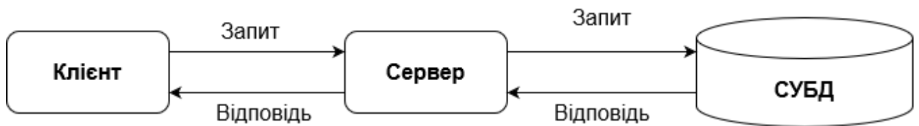
Рисунок 3.1 – Загальна схема архітектури «клієнт-сервер»
