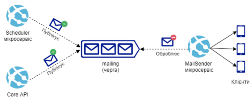
Рисунок 29. – Схема доставки повідомлень (email)
