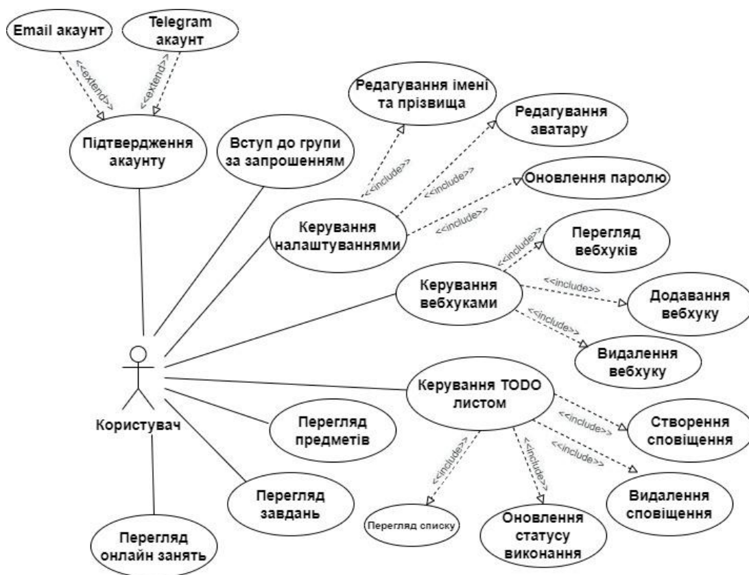
Рисунок 13. – Діаграма використання - користувач
