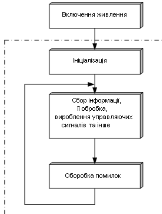
Рис1.4. Схема алгоритму програми-монітора
