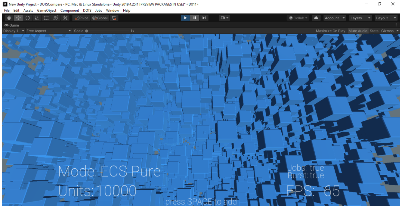
Рисунок 3.6 – Показники продуктивності при використанні ECS, Job System та Burst Compiler.
