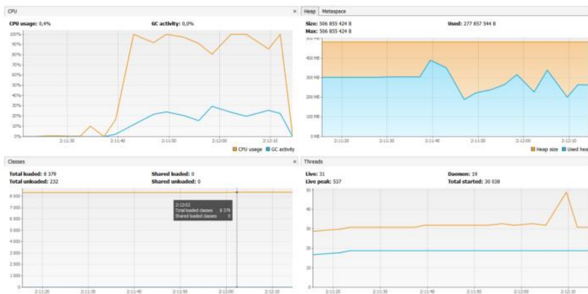
Рисунок 3.5 Профілювання WebFlux and Java Http Client для 200 користувачів мікросервісу за допомогою JMeter.
