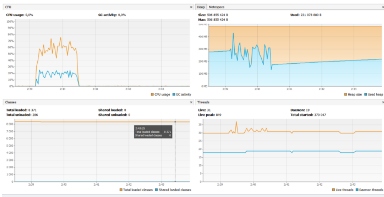
Рисунок 3.14 Профілювання на WebFlux and Java Http Client з 500 мс затримкою мікросервісу та 400 паралельними користувачами за допомогою JMeter
