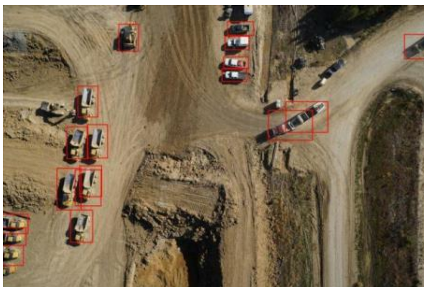
Рисунок 15 - Застосування мережі DetectNet для пошуку транспортних засобів
