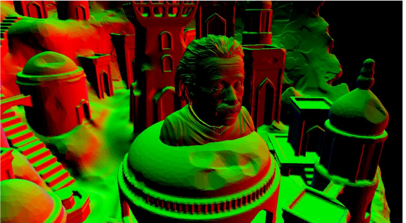
Рисунок 2.2.2.1 Текстура, де кожний фрагмент ( піксель ) має значення нормалі в системі координат камери
