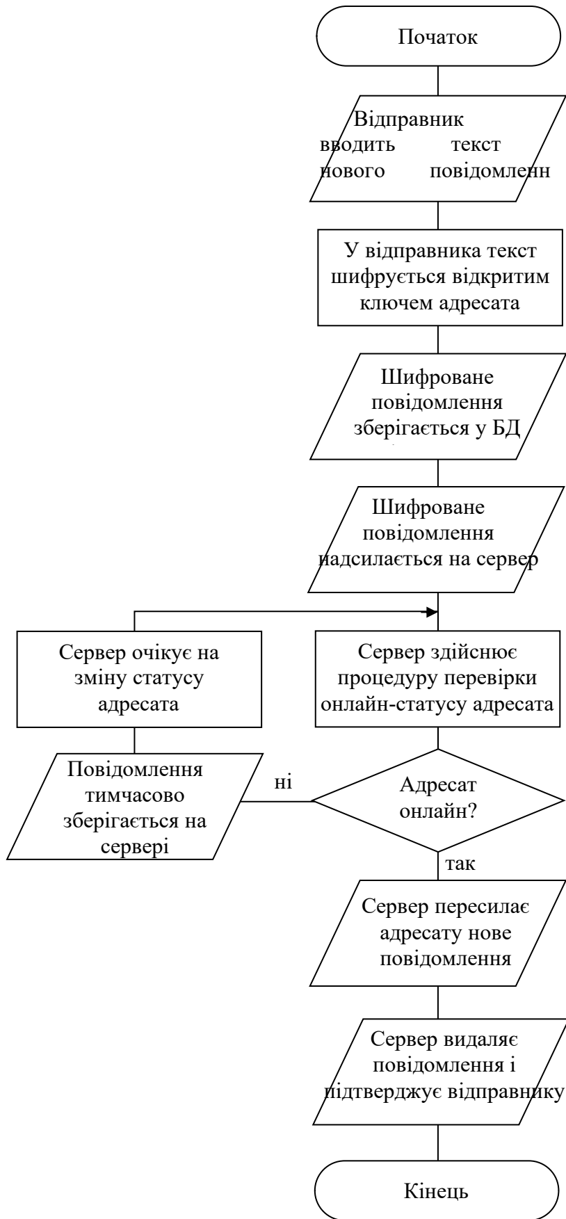
Рис. 2.3 Блок-схема алгоритму процесу проходження нового повідомлення через систему
