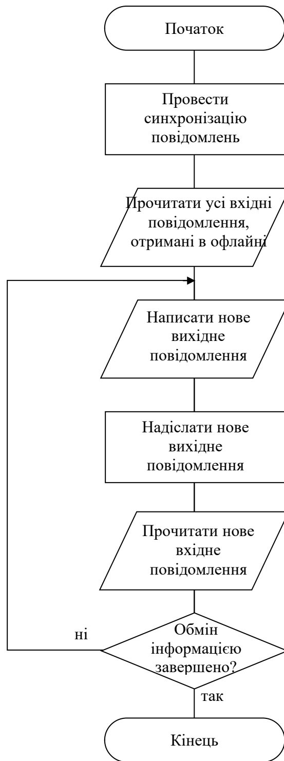
Рис. 2.2 Блок-схема алгоритму типового процесу роботи користувача месенджеру у цьому програмному продукті
