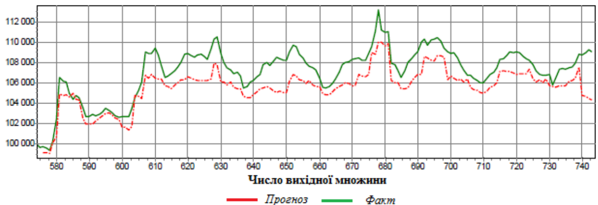
Рисунок 3.6 - Порівняння фактичної і прогнозної величини електроспоживання підприємства на перевірочній частині вихідної мнoжини даних «Квітень 2019»
