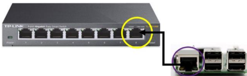
Рис.3.8. Підключення датчика Pi до порту моніторингу TP-LINK
