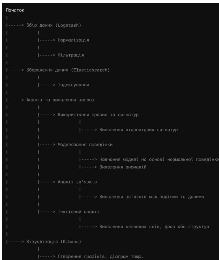
Рис. 1.6 – Процес аналізу та виявлення загроз у SIEM ELK STACK, включаючи збір, збереження, аналіз даних та їх візуалізацію
