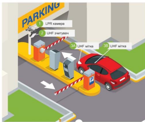
Рис. 2.1 Структура системи (LPR) та (UHF) на паркувальних майданчиках
