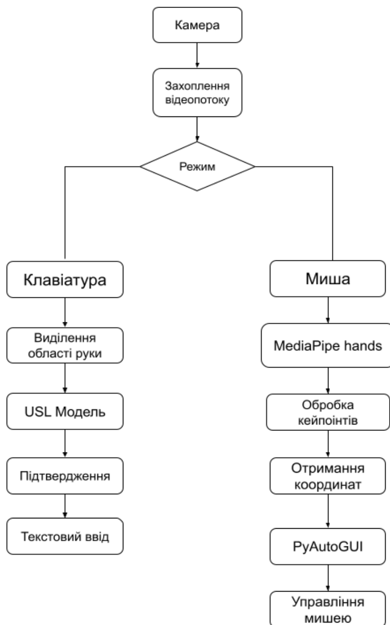
Рис. 3.2 Блок-схема роботи системи в режимах "Миша" та "Клавіатура"
