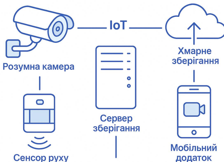
Рисунок 1.1 – Структурна схема системи відеоспостереження з інтеграцією IoT-пристроїв
