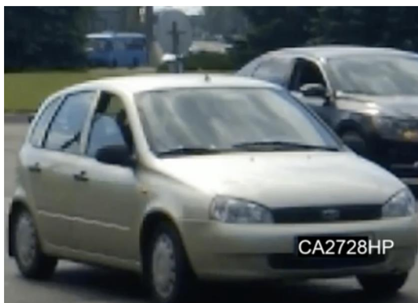
Рисунок 3.18 – Відображення розпізнаного номеру на зображенні
