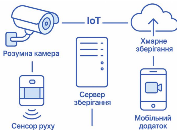
Рис. 1.1 – Структурна схема системи відеоспостереження з інтеграцією IoT-пристроїв
