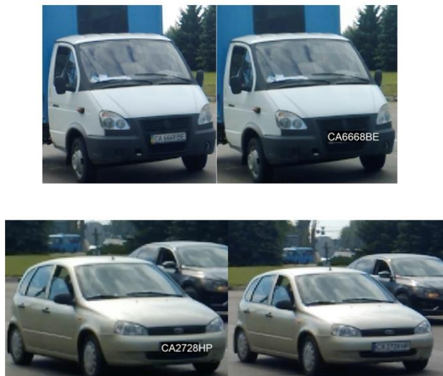
Рис. 3.1 – Початковий етап обробки: розбиття відео на кадри та локалізація номерного знака на кадрі відео
