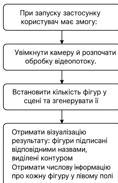
Рисунок 2.2 – Блок-схема функціональної взаємодії компонентів застосунку
