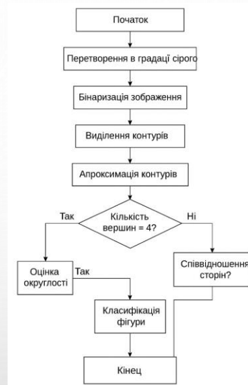
Рисунок 2.4 – Блок-схема алгоритму розпізнавання геометричних фігур у системі комп'ютерного зору
