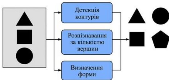
Рисунок 1.2 – Інтеграція класичних методів комп'ютерного зору та ІШ у процесі розпізнавання геометричних об'єктів
