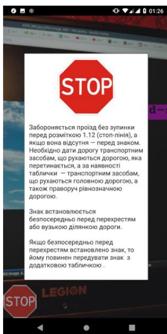
Рисунок 3.9 - Результат розпізнавання дорожнього знаку в системі
