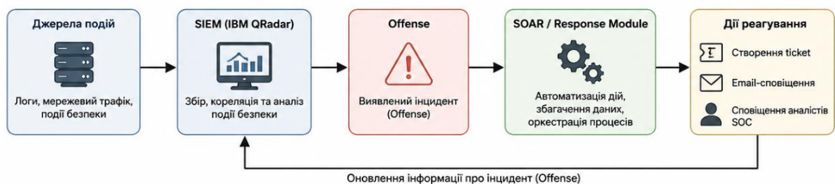
Рис.1.3. Схема взаємодії SIEM та SOAR у процесі реагування на інциденти
