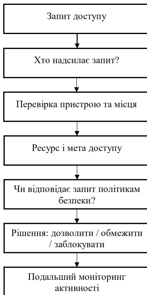
Рис. 1.3. Логіка прийняття рішення про доступ за концепцією Zero Trust
