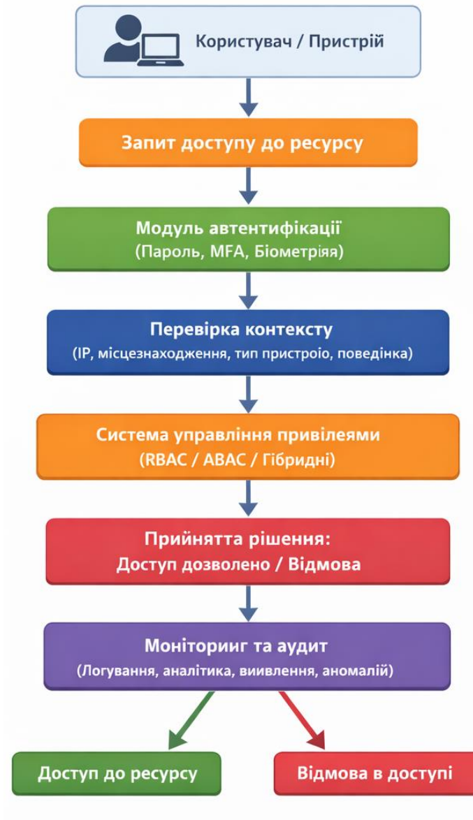
Рис. 2.1 Процес автентифікації та авторизації в сучасних системах на основі Zero Trust
