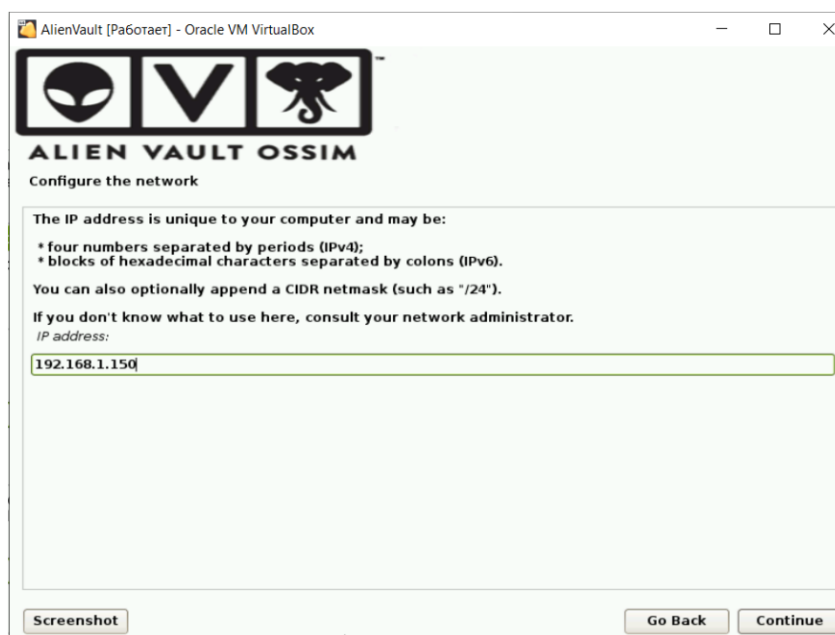
Рис. 3.9. Визначення IP-адреси для доступу до SIEM-системи OSSIM
