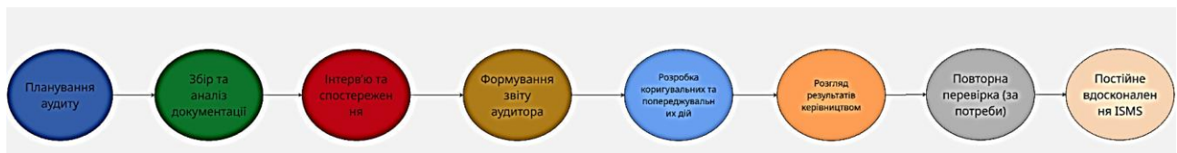
Рис. 3.4. Послідовність проведення внутрішнього аудиту
