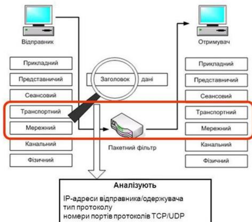
Рис. 2.11 Принцип роботи фільтрації пакетів
